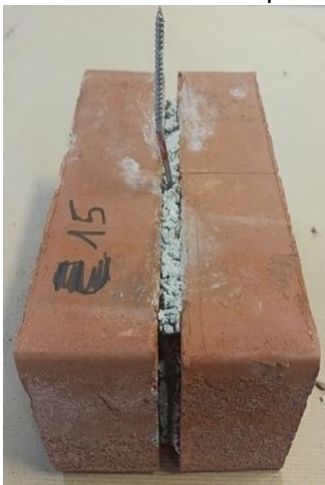
Figure 54 – Essais de compression - Flambement de l'attache filaire après essai de compression sur doublets de briques perforées montées à joint épais & Désolidarisation d'une brique de certaines maquettes.
