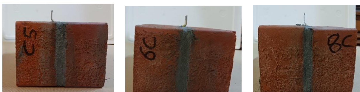
Figure 62 – Essais de compression - Flambage de l'attache sans désolidarisation de la maquette ni fissuration du mortier.
