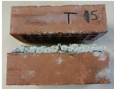
Figure 53 – Essais de traction - Désolidarisation des maquettes une des interfaces brique mortier
