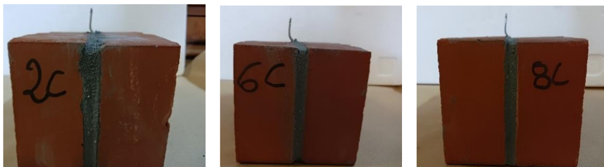
Figure 66 – Essais de compression - Flambage de l'attache sans fissuration du mortier
