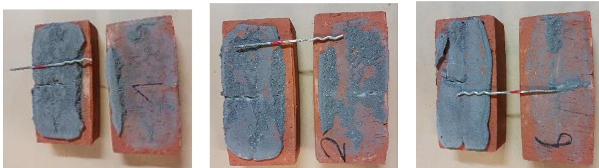
Figure 55 – Essais de traction - Désolidarisation des maquettes sur une des interfaces brique mortier & Désolidarisation de l'attache du joint de mortier.
