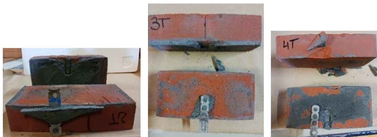
Figure 64 - Essais de traction - Désolidarisation des maquettes au niveau de l'interface brique-mortier. La quasi-totalité du mortier reste sur l'une des faces d'une des briques. L'attache se déchausse du mortier
