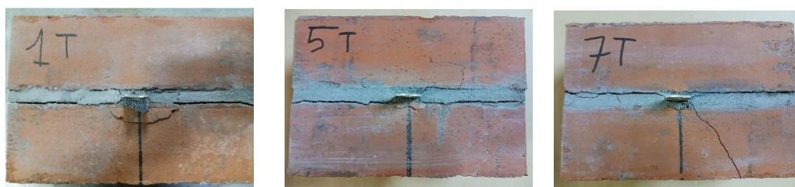
Figure 59 – Essais de traction - Fissuration des maquettes à l'interface brique-mortier avec léger déplacement de l'attache et fissure sur une des briques
