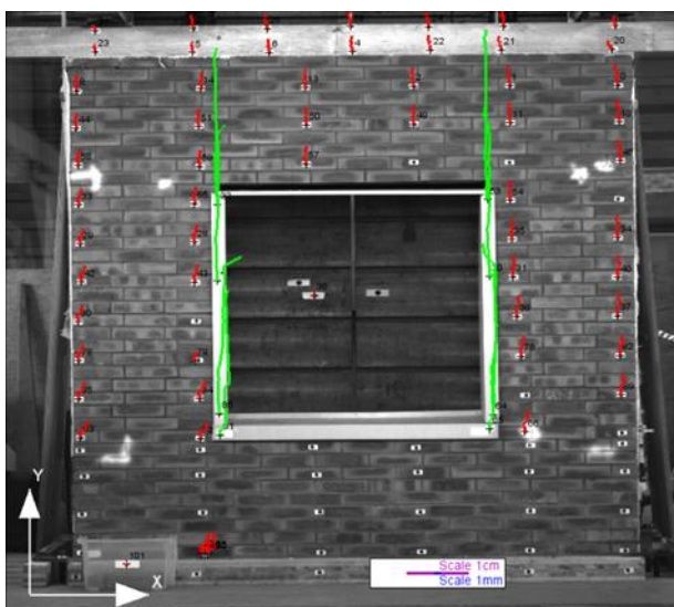
Figure 110 - Essais de déformation différentielle jusqu'à 30mm - attaches filaires, briques perforées
