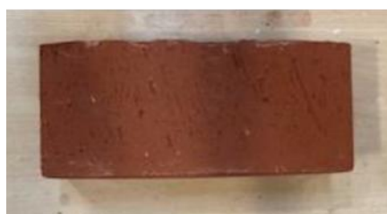
Figure 46 – Brique pleine de type U (Brique Terre rouge HTR WF de la société Wienerberger) de dimensions 215 x 102 x 50 mm
