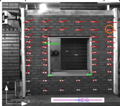
Figure 107 - Déplacement d'ensemble de la maquette pendant l'essai de mise en parallélogramme - attaches filaires, briques perforées
