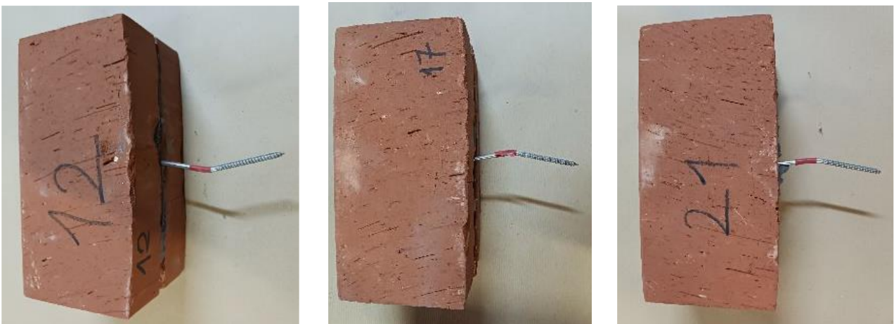
Figure 58 – Essais de compression - Flambage de l'attache des maquettes
