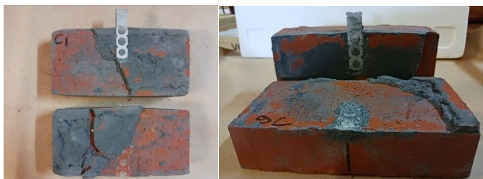
Figure 65 - Essais de compression - Désolidarisation des maquettes au niveau de l'interface brique-mortier. Une partie du mortier reste sur l'une des faces d'une des briques. Une autre partie demeure sur l'autre face, et le reste du mortier et l'attache se désolidarisent du montage.
