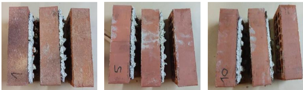
Figure 51 - Faciès de rupture des éprouvettes de cisaillement, brique perforée montée à joint épais
