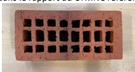
Figure 45 – Brique perforée de type U (Brique TAIGA de la société Briqueteries du Nord) de dimensions 220 x 105 x 65 mm
