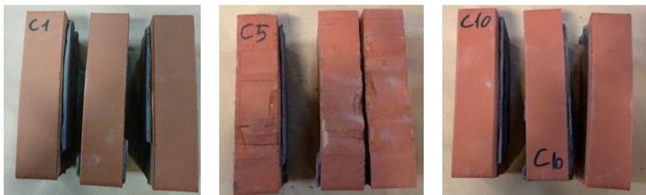
Figure 52 - Faciès de rupture des éprouvettes de cisaillement, brique pleine montée à joint semi-épais
