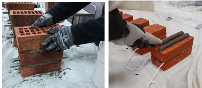
Figure 50 - Montage des échantillons pour l'essai de cisaillement sur briques perforées montées à joint épais (à gauche) et briques pleines montées à joint semi-épais (à droite)
