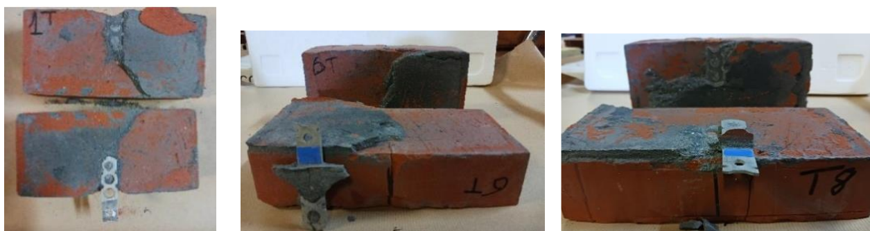
Figure 63 - Essais de traction - Désolidarisation des maquettes au niveau de l'interface brique-mortier. Une partie du mortier reste sur l'une des faces d'une des briques, le restant du mortier reste sur la face de la deuxième brique de la maquette. L'attache se déchausse du mortier
