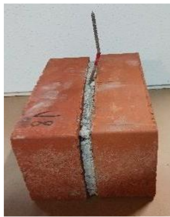
Figure 54 – Essais de compression - Flambement de l'attache filaire après essai de compression sur doublets de briques perforées montées à joint épais & Désolidarisation d'une brique de certaines maquettes.
