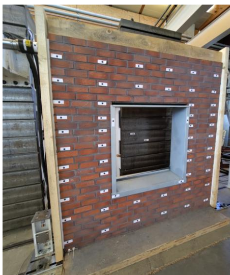
Figure 99 - Maquette d'essai avec baie pour l'essai de vieillissement mécanique cyclique
