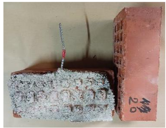
Figure 54 – Essais de compression - Flambement de l'attache filaire après essai de compression sur doublets de briques perforées montées à joint épais & Désolidarisation d'une brique de certaines maquettes.
