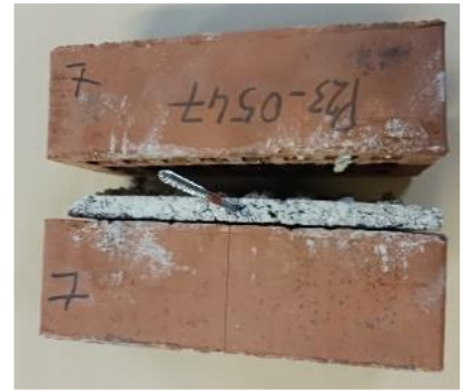
Figure 53 – Essais de traction - Désolidarisation des maquettes une des interfaces brique mortier
