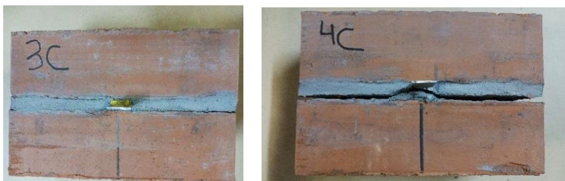
Figure 61 – Essais de compression - Fissure des maquettes à l'interface brique mortier sans déformation ni déplacement de l'attache
