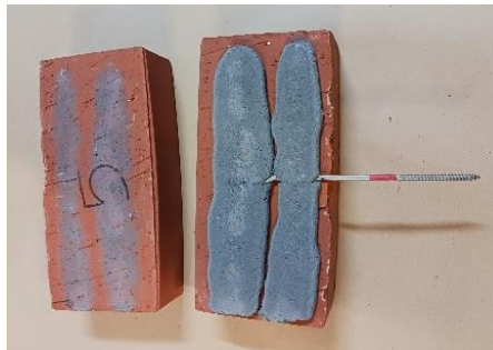
Figure 57 – Essais de traction - Désolidarisation de la maquette n°5 sur une des interfaces brique mortier. L'attache reste figée dans le joint de mortier.
