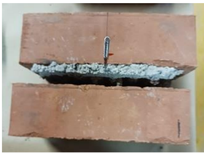
Figure 53 – Essais de traction - Désolidarisation des maquettes une des interfaces brique mortier
