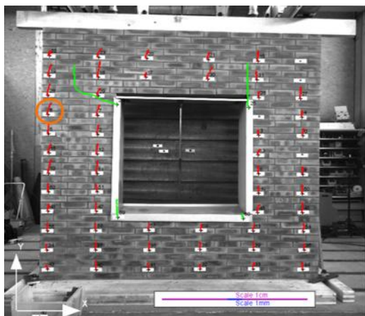
Figure 105 - Déplacement d'ensemble de la maquette pendant l'essai de déformation différentielle - attaches filaires, brique pleine
