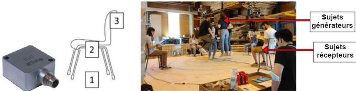
Figure 19 - Placement des accéléromètres sur les chaises des récepteurs et illustration d'un essai
