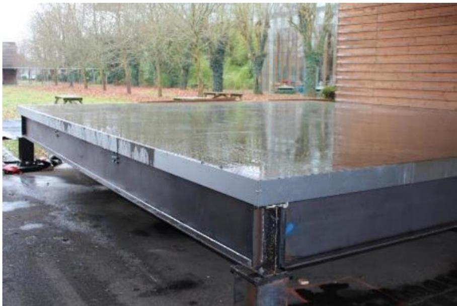
Figure 12 : Vue du plancher acier après coulage de la dalle béton
