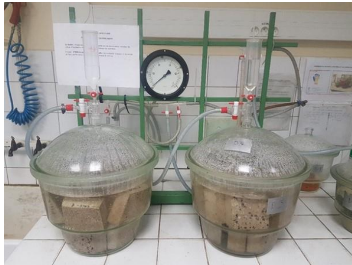
Figure 45 - Différents outils pour la saturation sous vide
