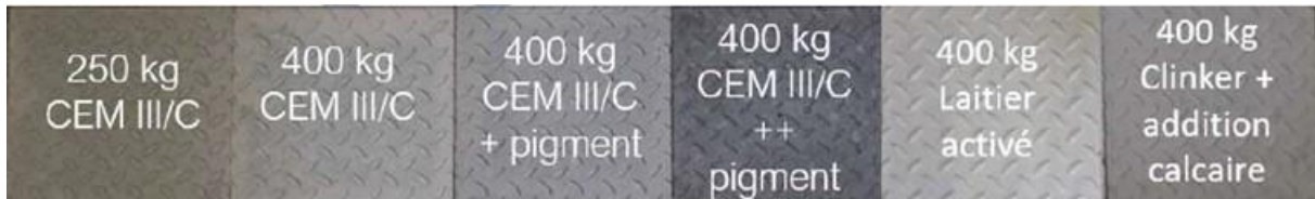
Figure 30 - Présentation des teintes des 6 formulations employées (pavé 1 à gauche à pavé 6 à droite)
