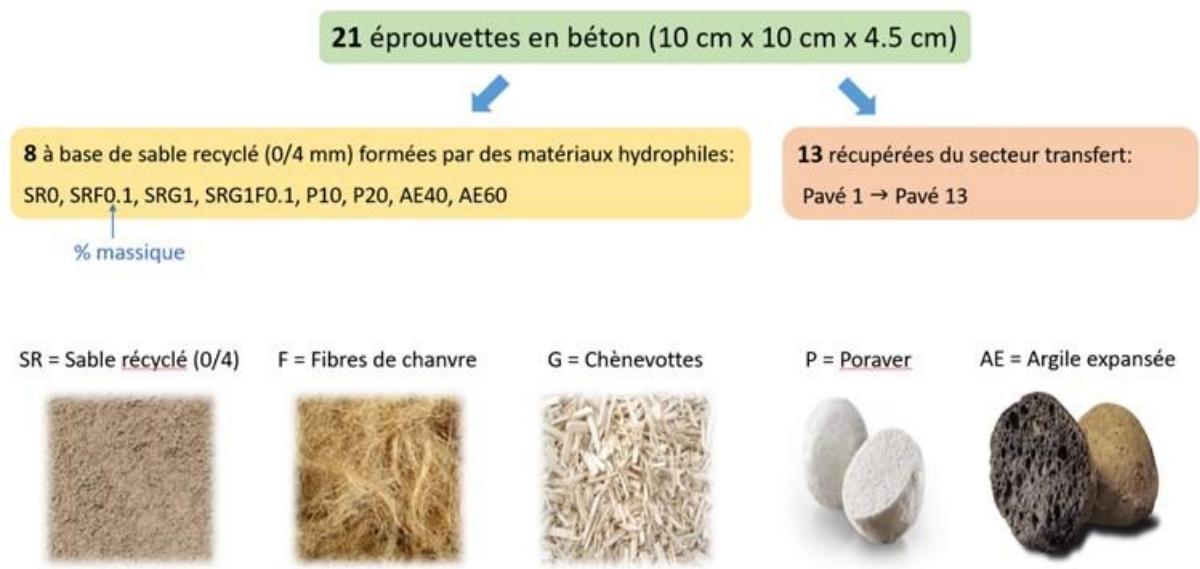
Figure 44 - Schéma de la formulation/composition des éprouvettes à tester
